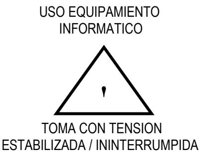
Los circuitos ATE deberán tener como máximo quince (15) bocas, sin limitación de potencia de salida de cada una, tipo de alimentación, ubicación, conexionado o dispositivos a la salida, ni de potencia total del circuito o de valor de la protección. Es responsabilidad del proyectista determinar esas características, cumpliendo lo establecido con carácter general en esta Reglamentación.
